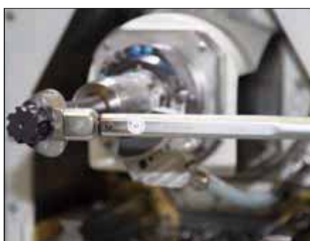
Výměnnou hlavu utáhněte pomocí momentového klíče a vhodného očkového nástrčného klíče na stanovený utahovací moment (viz tabulka „Utahovací momenty výměnných hlav“).
