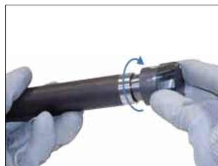
Výměnnou hlavou rukou pevně zatočte ve směru otáčení hodinových ručiček do držáku výměnné korunky. Poté držák výměnné hlavy včetně nástroje upněte do strojního držáku.
