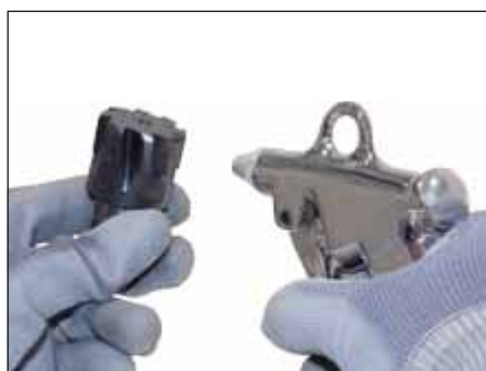
Kužel, závit a rovnou plochu výměnné hlavy vyčistěte stlačeným vzduchem a utěrkou.
