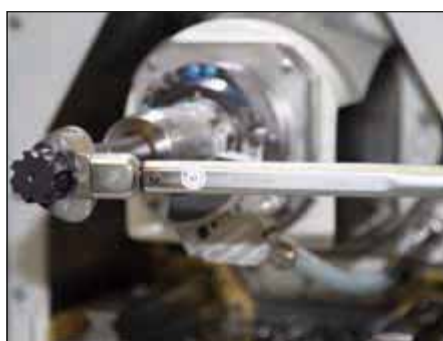
Momentový klíč přiložte pokud možno vodorovně k výměnné hlavě a přitom plochu klíče nevychyľte ze svislé polohy.
