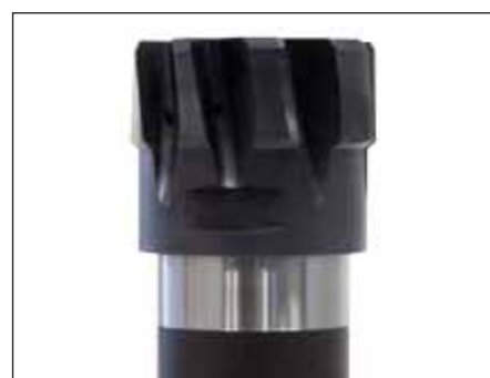
Výměnnou hlavou rukou pevně zatočte ve směru otáčení hodinových ručiček do držáku výměnné korunky. Poté držák výměnné hlavy včetně nástroje upněte do strojního držáku.
